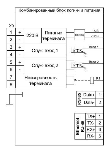
Обеспечение связи терминала с АСУ ТП
